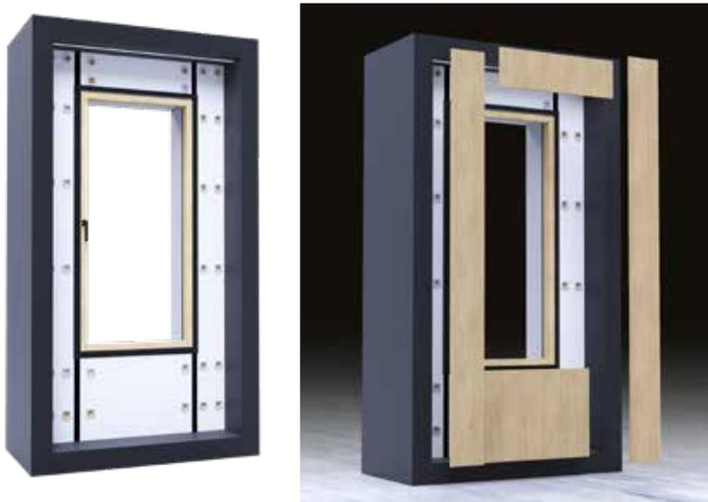
**5** | **Befestigung der Abdeckplatten**
